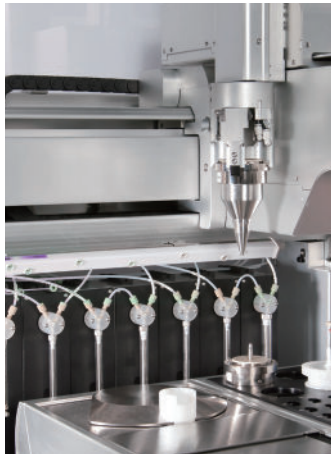
典型储料器采用主动搅拌， 确保流速均匀
