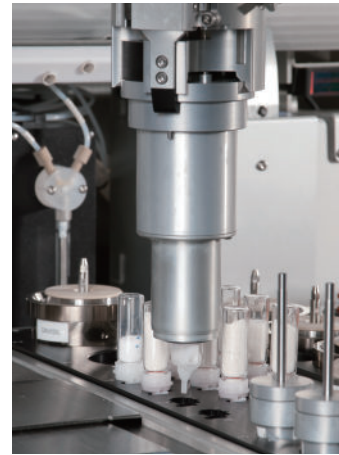
SV分配器通过振动实现精 确输送
