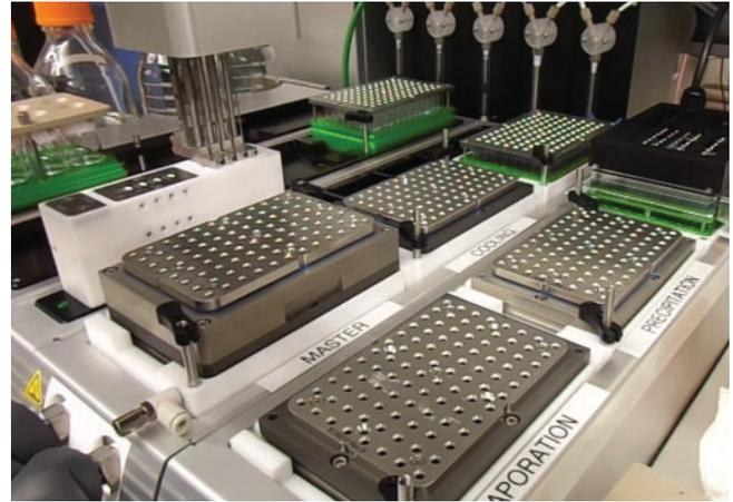
温控站上的加热过滤模块
