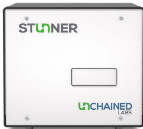
图 1: Stunner 是一款在同一个 2 \mu L 样品上汇集 UV/Vis、RADLS 和 MALS 数据的系统
